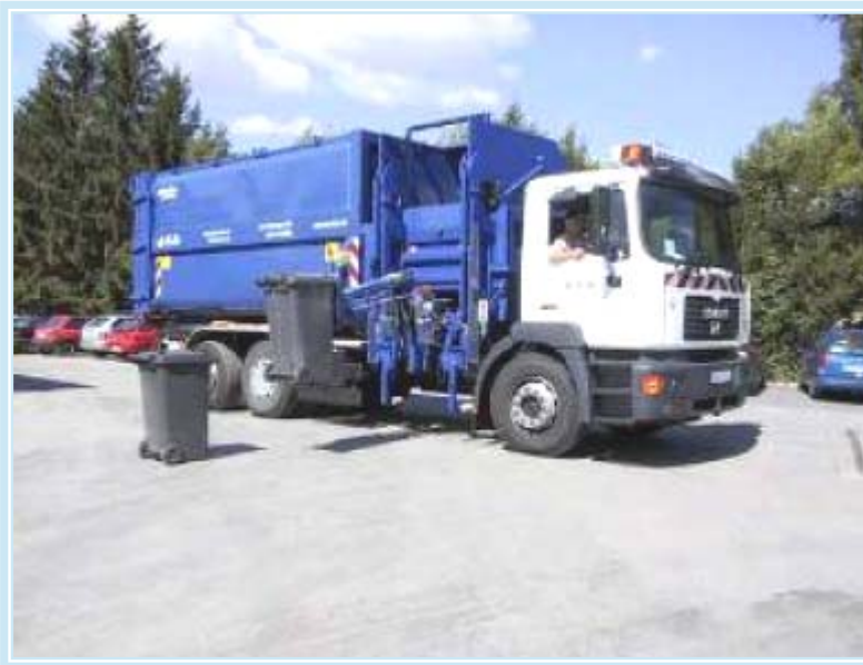
Vehículo de recogida con carga lateral
