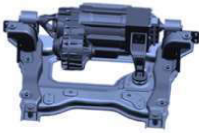
Subchasis de EV con integración del motor eléctrico
