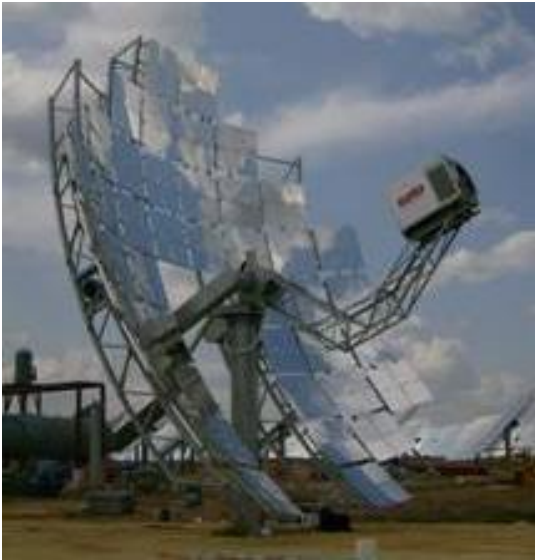
Pruebas de discos "stirling" en la plataforma solar de Sanlúcar la Mayor (Sevilla)
