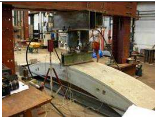
Dovela bicapa durante uno de los ensayos del proyecto
