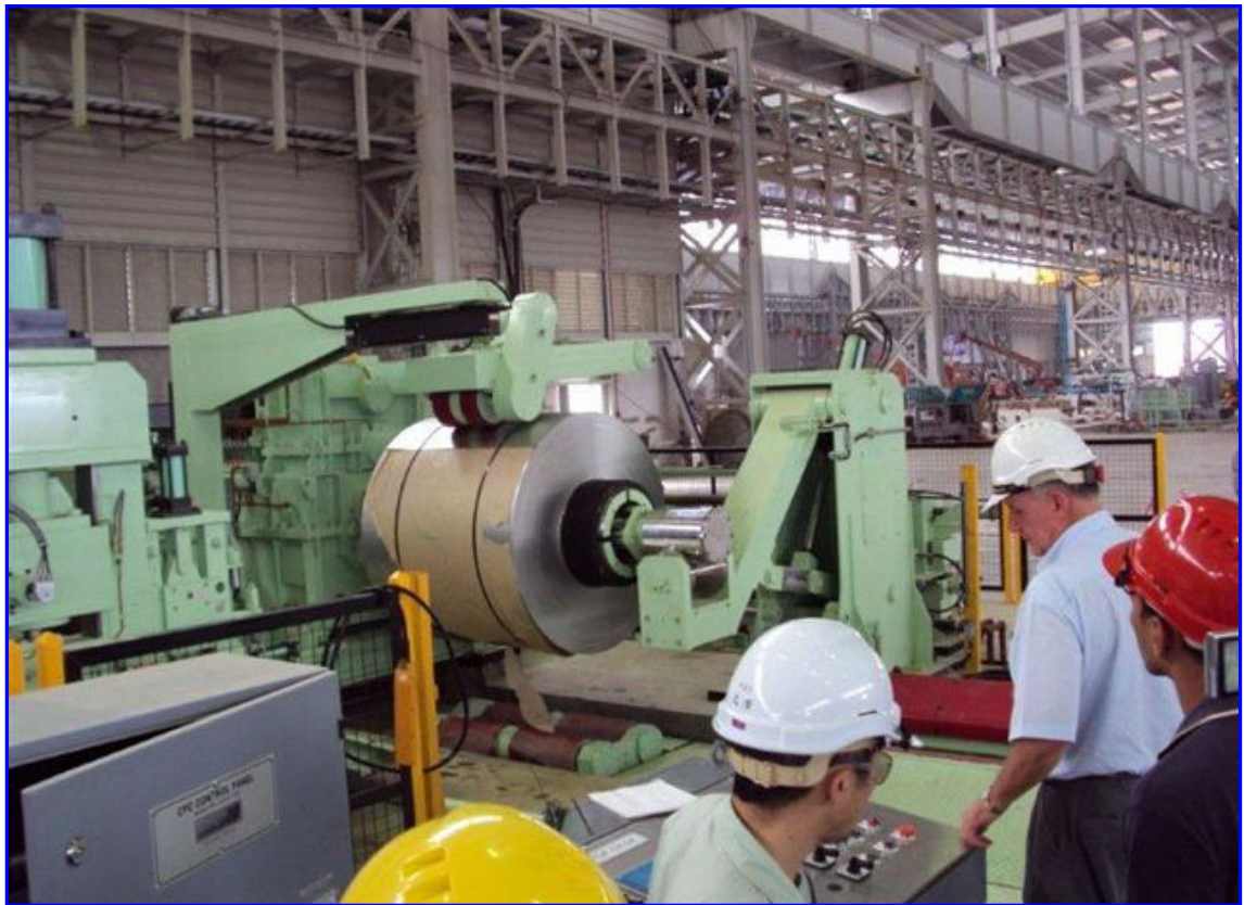
Primera bobina procesada en la línea de corte longitudinal
