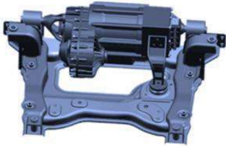
Subchasis de EV con integración del motor eléctrico
