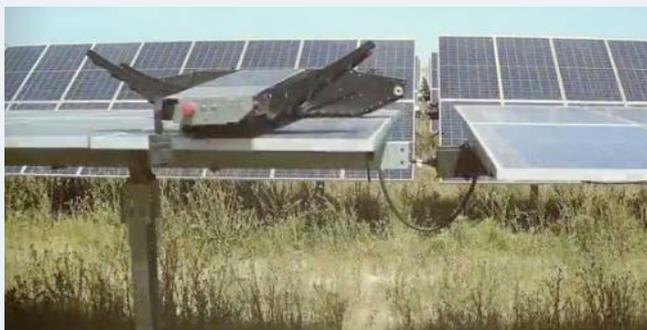
*Robot para la limpieza automática de módulos fotovoltaicos.*
